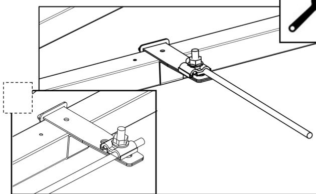
4. Serrez l'écrou pour fixer le support sur la poutre avec une clé à molette de 17 mm (**20 Nm**). \*Peut aussi être monté à un angle de 90 degrés.
