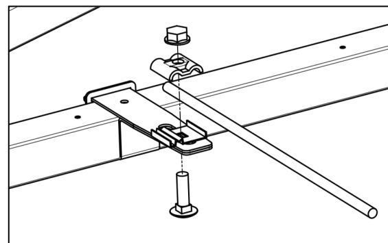
3. Insérez la boulon de chariot M10x25 dans le trou longitudinal par en dessous. Montez la borne de terre avec le paratonnerre.
