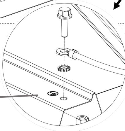
Utilisez un boulon M6x20 avec une rondelle à dents et un écrou correspondant. **Serrez à 8-10 Nm.**
