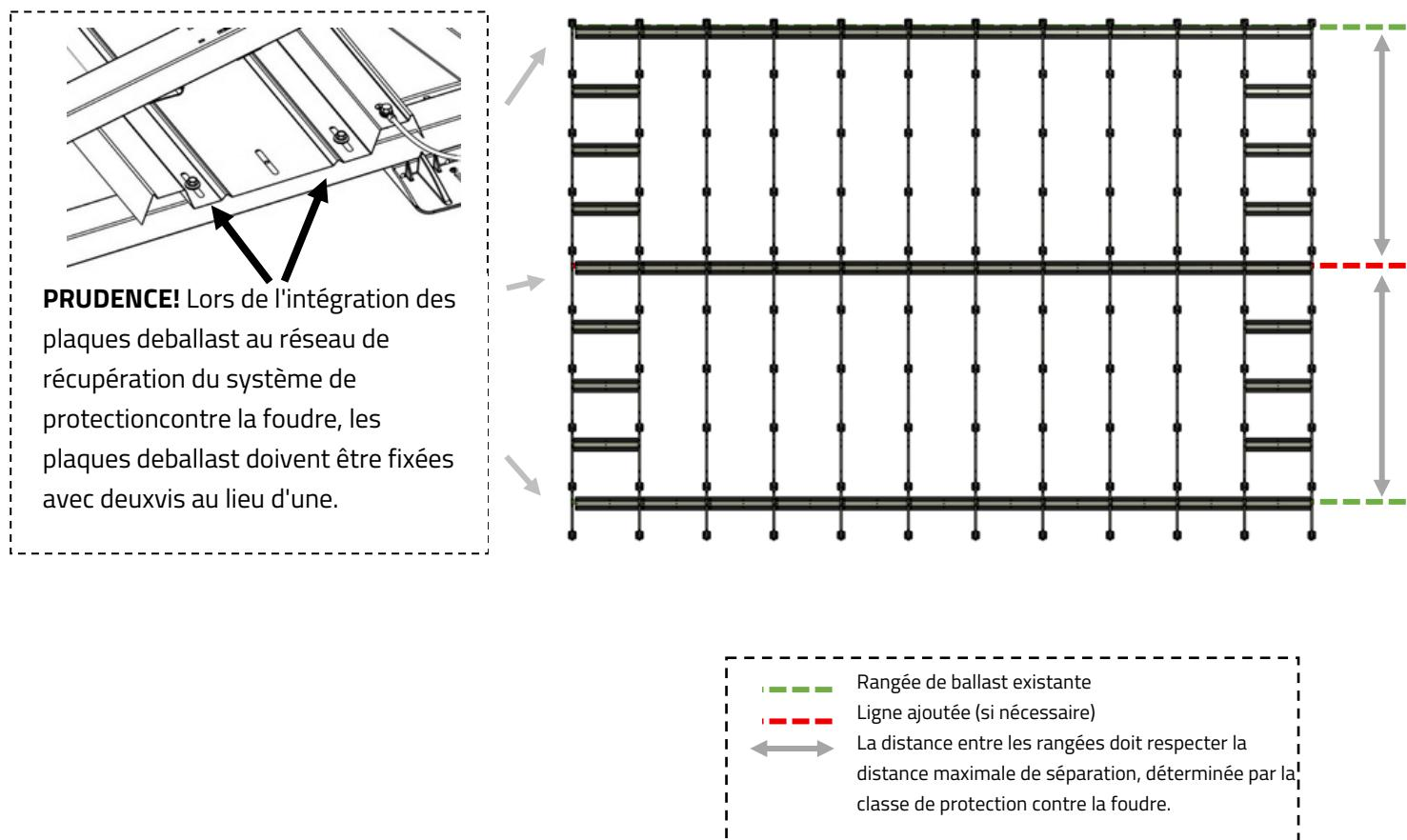
**PRUDENCE!** Installer des rangées supplémentaires de plaques de ballast pour les grands champs afin de respecter la distance maximale de séparation, selon la Classe de Protection contre la Foudre 1 (5x5 m), 2 (10x10 m), 3 (15x15 m), 4 (20x20 m).
